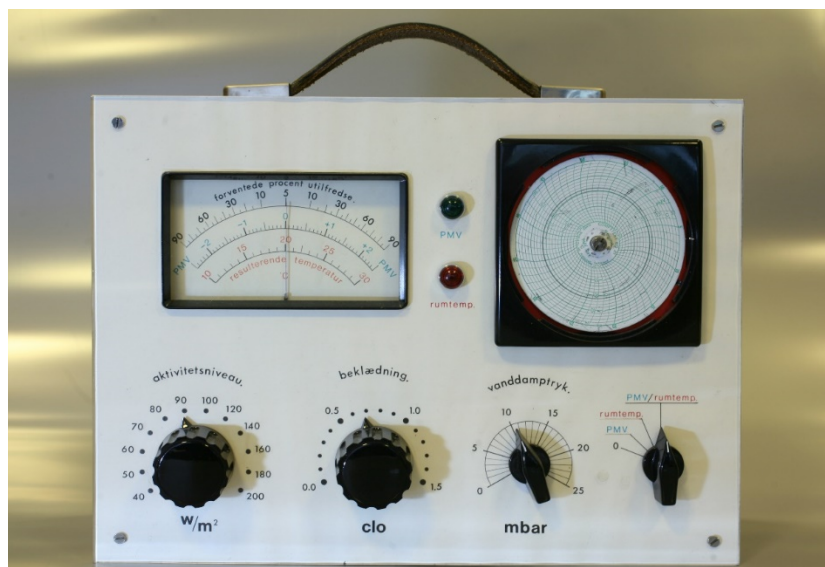
Et komfortmeter er et inskriptionsapparat. Det måler indeklimaet eller rettere, den "forventede procent utilfredse" i et lokale ved forskellig temperatur og luftfugtighed. Læg mærke til, at man skal indstille på apparatet, hvor meget folk bevæger sig, og hvor meget tøj, de har på.
