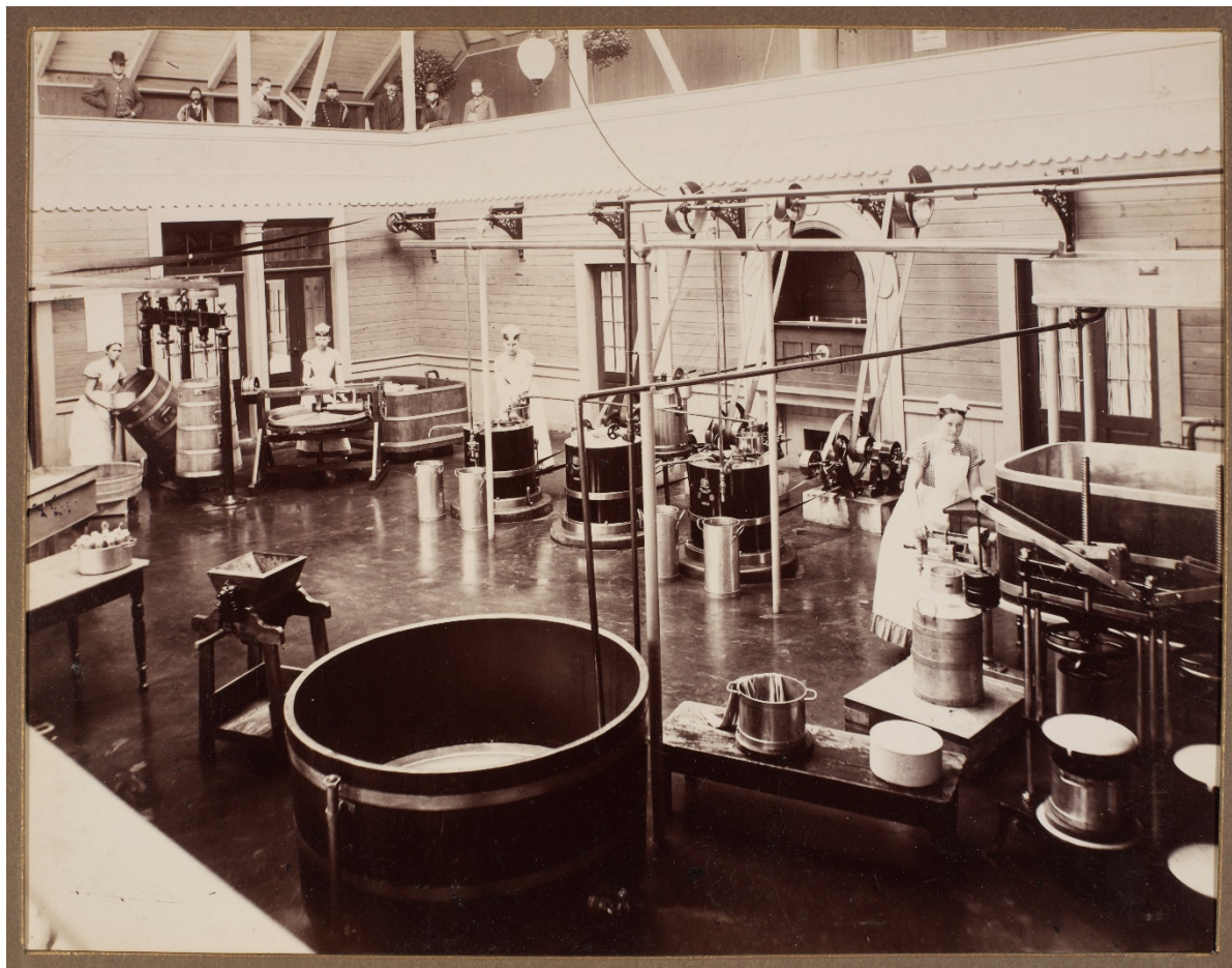
På industriudstillingen i København i 1888 viste man stolt et helt mejeri frem. Læg mærke til transmissionssystemet , der forbinder centrifugerne med en dampmaskine .
