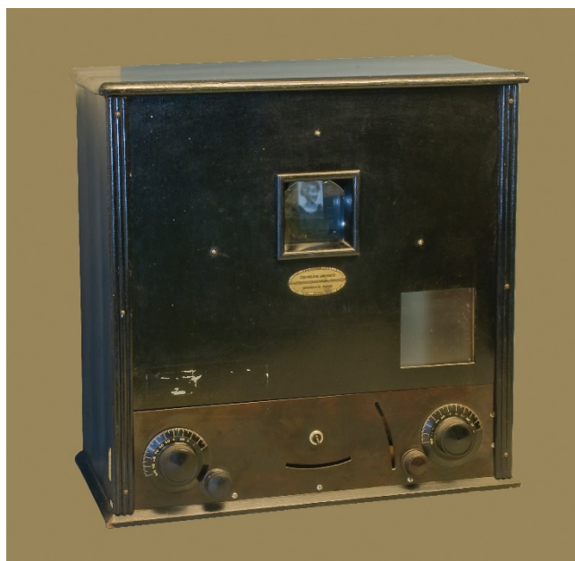
Hjemmebygget mekanisk fjernsyn. Apparater som dette fik bladet Populær Radio til at skrive, at "fjernsynet vil bidrage til at udslutte grænser og hadet mellem nationerne".
