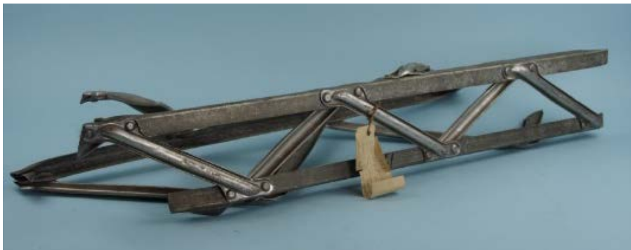
I 1915 nødlandede det tyske luftskib L3 på Fanø. For at beskytte datidens højteknologi skød besætningen luftskibet i brand efter landingen. Denne rest er bevaret på DTU. Diagonalerne er af rent aluminium, mens resten er af en stærkere legering af aluminium, kobber og zink.
