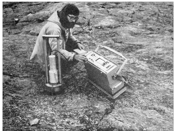
Figur 32. Poul Sørensen henholdsvis i gang med at logge et borehul og foretage vinduestællinger med den nye version af feltgammaspectrometret. Foto: GGU.
