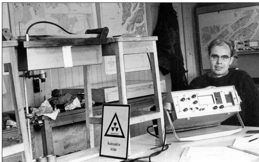
Figur 14. Opmåling af detekteringsarealet for den midlertidige udgave af beryllometer II i mit logi i Dyrnæs. Foto: Erling Johannsen.
