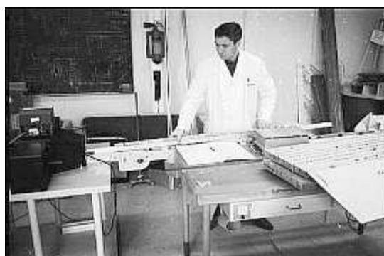
Figur 23. Gammaspektrometer til scanning af borekerne i mellemrummet mellem to modsat rettede NaI(Tl) detektorer afskærmet med blokke af antimonbly. På fotoet øverst til højre foretager Erling Johannsen en tareret vejning af en borekernesektion, der skulle scannes kontinuerligt for at bestemme dens gennemsnitlige indhold af uran og thorium. Nederst får Erling enden af slæden, som borekernen hviler på, til at fange transportbåndet inde i opstillingen.
