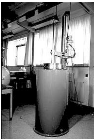
Figur 21. Laboratorie-gammaspektrometer til uran-thorium analyse i 4\pi målegeometri af 10-15 gram pulveriseret bjergart. I baggrunden på fotoet til venstre skimtes "Minen" ombygget til et gammaspektrometer, der akkommoderede en pulvermængde på 220 til 240 gram.
