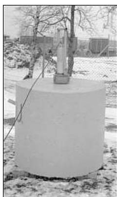
Figur 33. Den kollimerede detektor for feltgammaspektrometeret i kalibreringsposition på toppen af U-betonblokken og sonden for loggeudstyret indsat i røret gennem Th-betonblokken.
