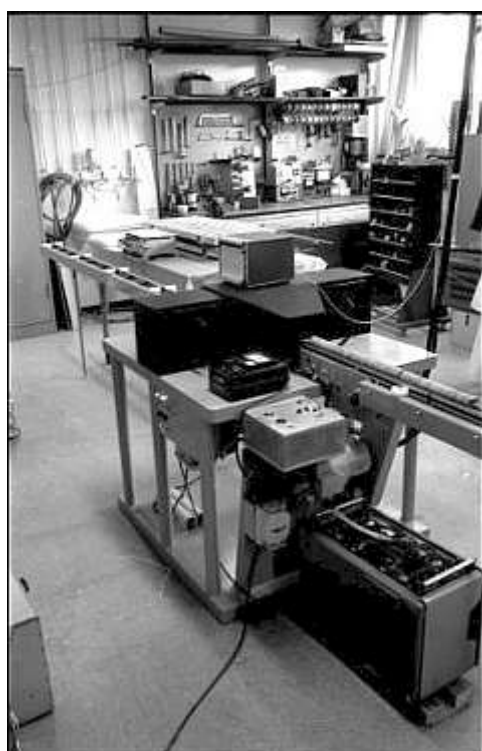
Figur 23. Gammaspektrometer til scanning af borekerne i mellemrummet mellem to modsat rettede NaI(Tl) detektorer afskærmet med blokke af antimonbly. På fotoet øverst til højre foretager Erling Johannsen en tareret vejning af en borekernesektion, der skulle scannes kontinuerligt for at bestemme dens gennemsnitlige indhold af uran og thorium. Nederst får Erling enden af slæden, som borekernen hviler på, til at fange transportbåndet inde i opstillingen.
