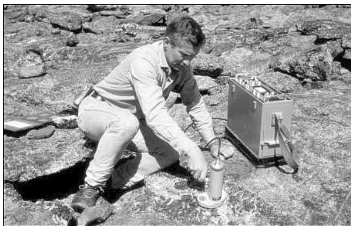
Figur 28. Erling Johannsen i færd med måle den karakteristiske røntgenfluorescensstråling exciteret i de sjældne jordarters metaller lanthan og cerium i en mineral-åre på kvane fjeldsplateauet. Foto: GGU.
