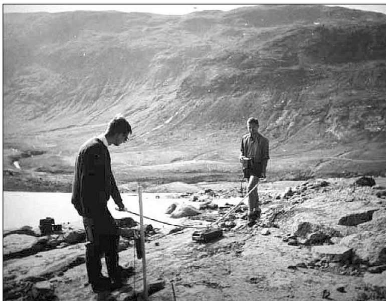
Figur 25. Prøvescanning med beryllometer II øverst på Taseq skråningen foretaget i sommeren 1968 af Erling Johannsen (bagerst) og kemiingeniør Gert Asmund, som på vegne af GGU foretog miljømæssige vurderinger af eventuel fremtidig minedrift på Kvanefjeld, der ses i baggrunden. Bemærk sneen til venstre i billedet, der ligesom i feltsæsonen for 1967 forhindrede os i at scanne langt de fleste af beryllium-mineraliseringerne på skråningen. Foto: Bjarne Leth Nielsen.
