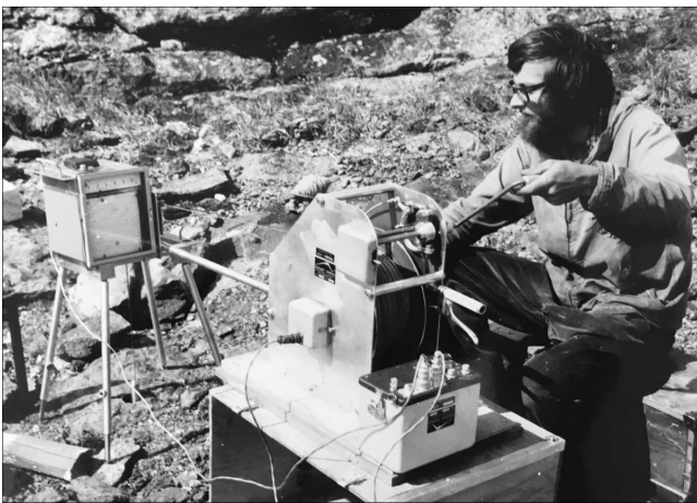
Figur 32. Poul Sørensen henholdsvis i gang med at logge et borehul og foretage vinduestællinger med den nye version af feltgammaspectrometret. Foto: GGU.
