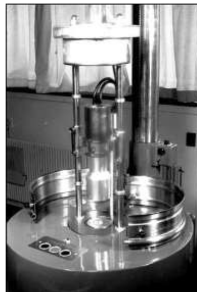
Figur 21. Laboratorie-gammaspektrometer til uran-thorium analyse i 4\pi målegeometri af 10-15 gram pulveriseret bjergart. I baggrunden på fotoet til venstre skimtes "Minen" ombygget til et gammaspektrometer, der akkommoderede en pulvermængde på 220 til 240 gram.
