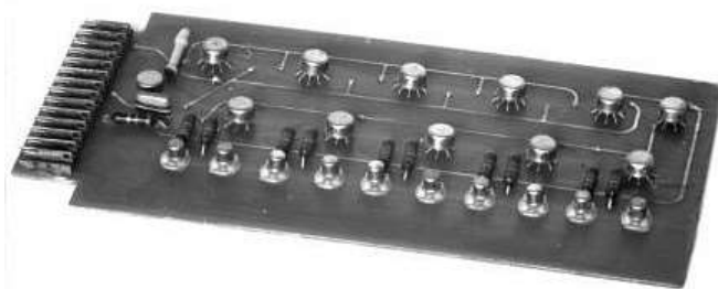
Figur 6. Printkort med komponenterne for den ene af analysatorens to éncifrede scalere (dekadetællere), som var opbygget af Fairchild integrerede Micrologic kredsløbelementer, henholdsvis den såkaldte flip-flop \mu L 926 (med ti ben) og gate elementet \mu L 914 (med otte ben). De ti transistorer i den forreste række styrede tændingen og slukningen af glødelamperne i lysdisplayet på analysatorens forplade.
