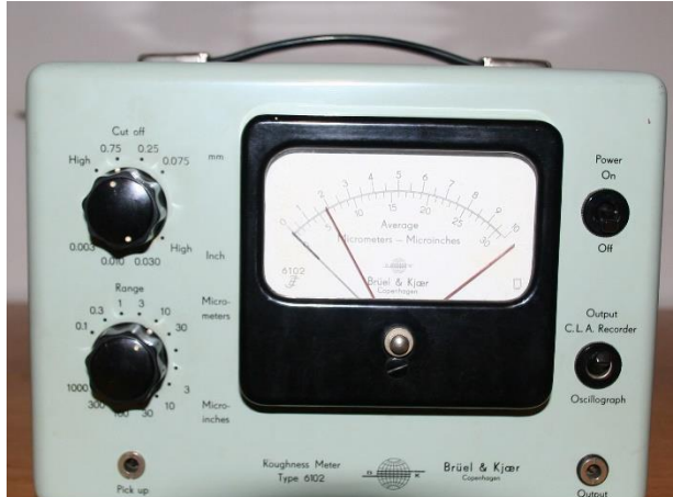
K.V. Olsen arbejdede med ruhedsmåling på DTH (i dag DTU). Hans arbejde var bl.a. grundlaget for denne ruhedsmåler fra Brüel & Kjær fra omkring 1960. Foto: Teknologihistorie DTU
