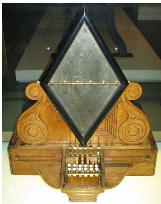
Figur 9. Cooke og Wheatstone brugte den elektromagnetiske effekt til at bevæge nåle i deres telegraf. Denne har fem nåle, som ved fælles hjælp kan pege på ethvert bogstav i alfabetet. Foto: Wikicommons.
