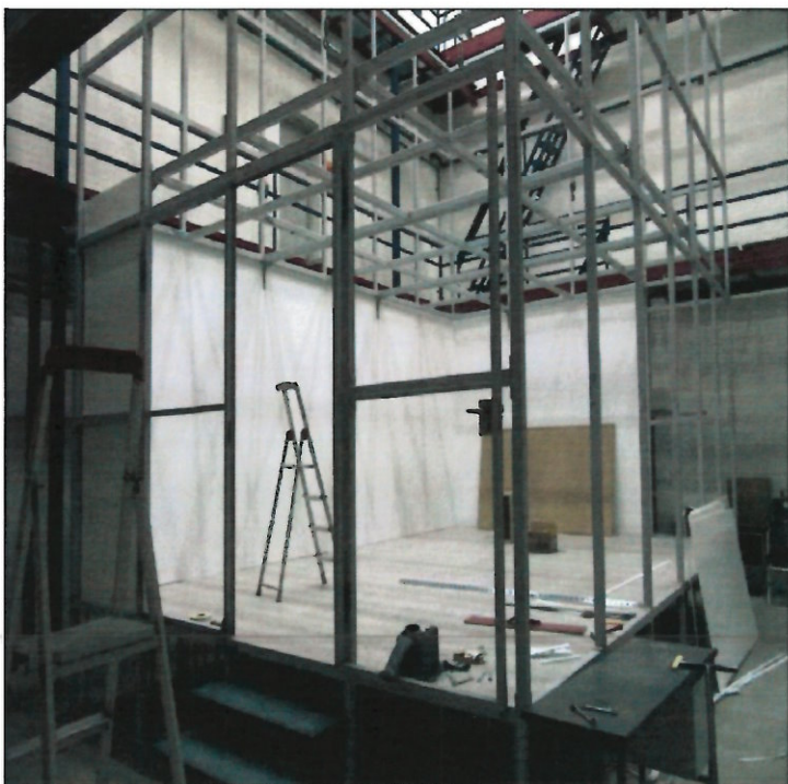
Klimakammer til studier af luftstrømninger i rum. Der kan ændres størrelse på kammeret, der også kan opdeles i flere separate kamre.
